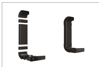
HEZ9VDKR0 montážní sada pro provoz s částečnou cirkulací pro varné desky s odsáváním, pro hloubku pracovní desky 70 cm a větší (2x ploché vertikální koleno 90° "L", 3x spojovací díl, 1x ploché potrubí 50 cm, 1x soklový difúzér) Cena: 3 490 Kč*
